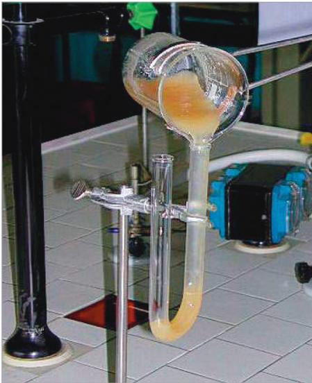
**FIGURA 5** Costruzione del ponte salino
