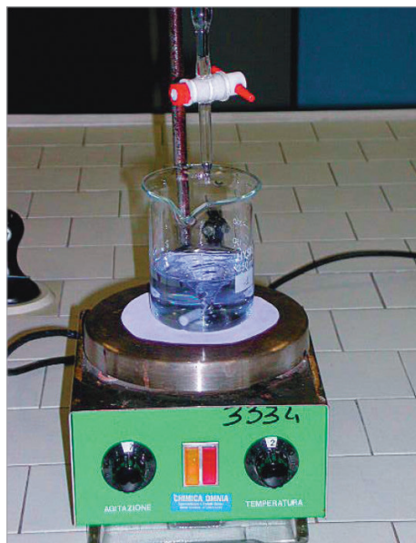
FIGURA 2 Titolazione al punto di viraggio
