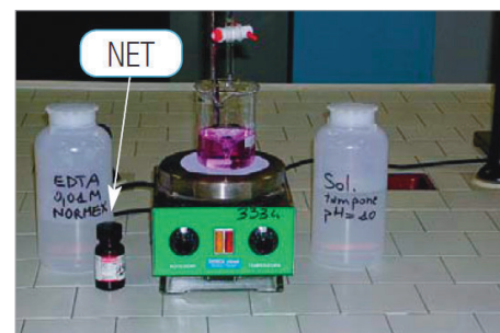
FIGURA 1 Titolazione prima del punto di viraggio
