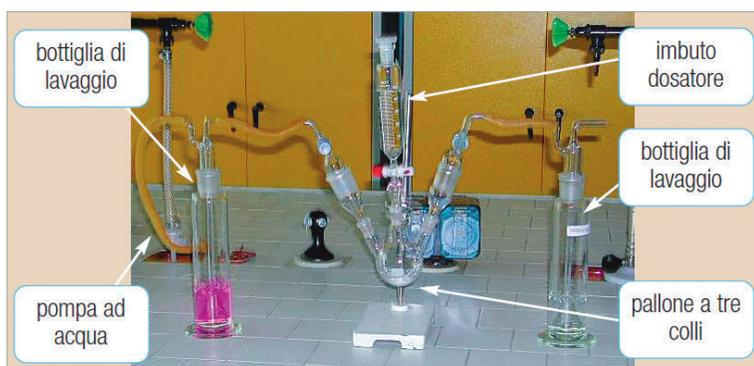
FIGURA 1 La strumentazione necessaria per la realizzazione dell'esperimento
