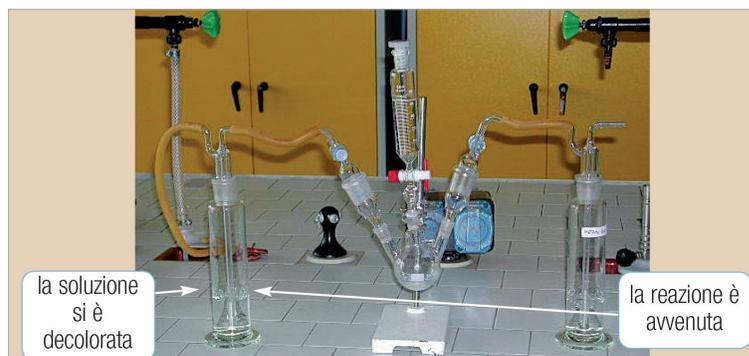
FIGURA 4 La strumentazione alla fine della reazione
