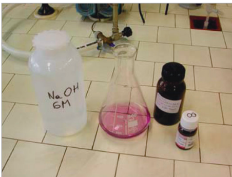
FIGURA 1 Alla soluzione fortemente basica si aggiunge l'indicatore acido calconcarbonico (calcon)
