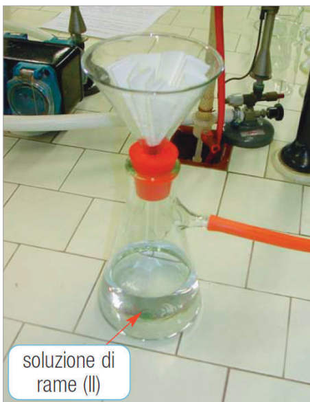
FIGURA 2 Filtrazione dell'idrossido ferrico
