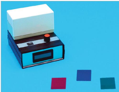
**FIGURA 2** Apparecchiatura per la determinazione della costante di Planck
