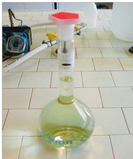
FIGURA 4 Si porta a volume (1l) la soluzione di nitrato ferrico
