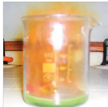
FIGURA 2 Inizio della dissoluzione di 1 euro cent (sotto cappa). Attenzione ai vapori di \text{NO}_2 !
