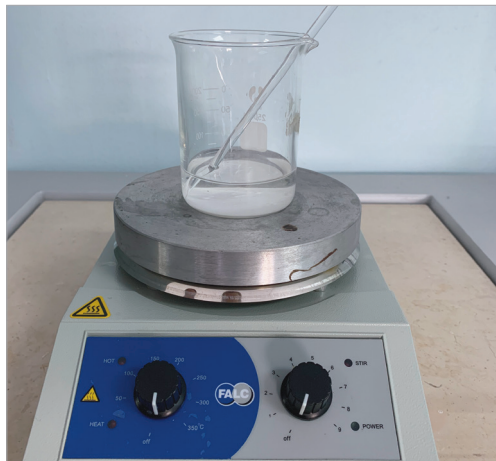
FIGURA 1 Reazione tra solfato di zinco ( \text{ZnSO}_4 ) e cloruro di bario ( \text{BaCl}_2 ) in ambiente acido
