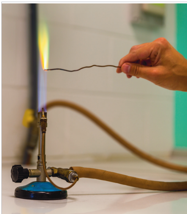
FIGURA 1 Apparecchiatura per il saggio alla fiamma
