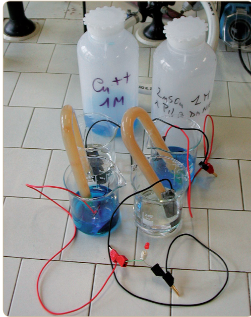
Figura 2 Due pile Daniell in serie accendono un led
