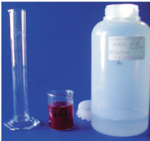
FIGURA 2 Formazione di precipitato rosso di idrossido ferrico [ \text{Fe}(\text{OH})_3 ]
