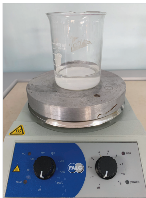
FIGURA 2 Formazione di solfato di bario \text{BaSO}_4
