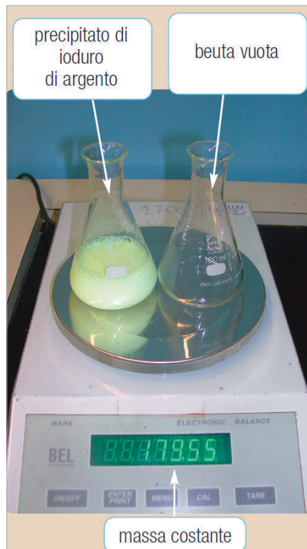
FIGURA 5 A reazione avvenuta la massa rimane costante (massa complessiva = 179,55 g)
