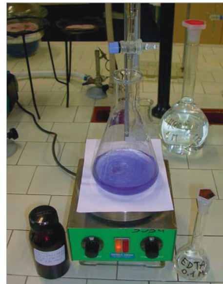
FIGURA 4 L'indicatore (calcon) al punto di viraggio
