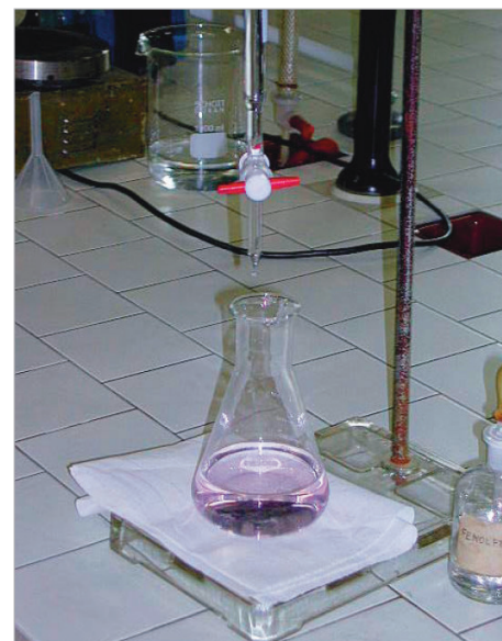
FIGURA 5 Colorazione corretta del punto di viraggio
