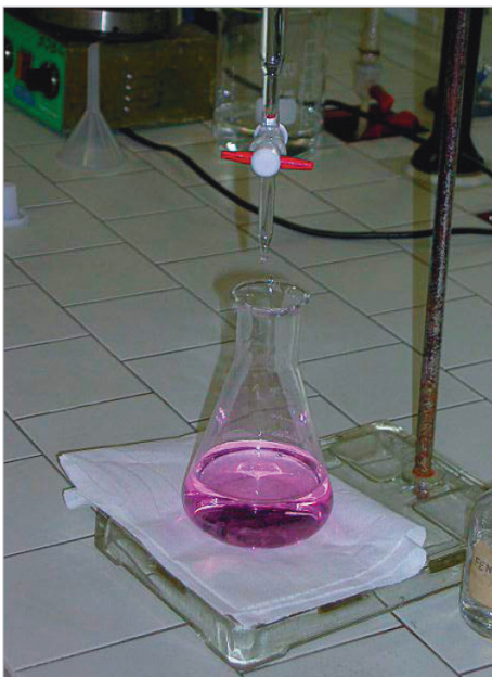
FIGURA 6 Colorazione errata del punto di viraggio
