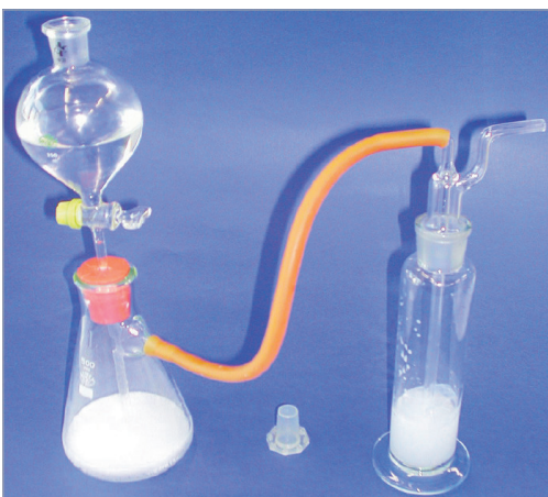
FIGURA 2 L'apparato gorgogliatore dopo la reazione di decomposizione di \text{CaCO}_3
