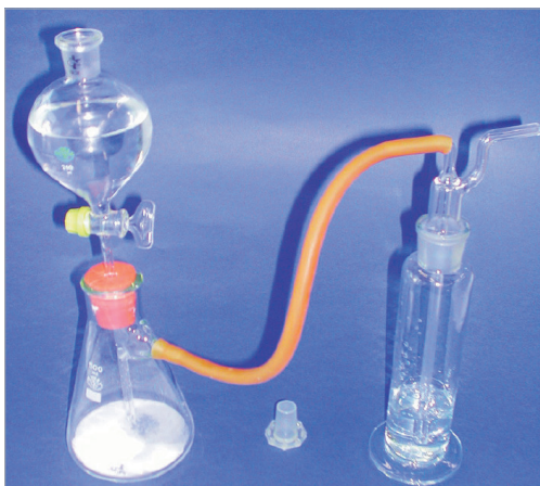
FIGURA 1 L'apparato gorgogliatore prima della reazione di decomposizione di \text{CaCO}_3
