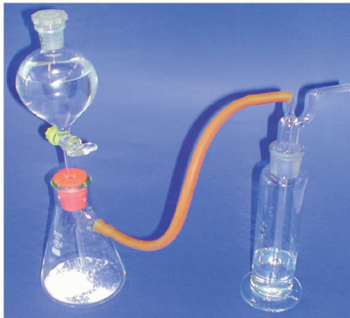
FIGURA 3 L'apparato gorgogliatore prima della reazione di decomposizione di \text{NaHSO}_3
