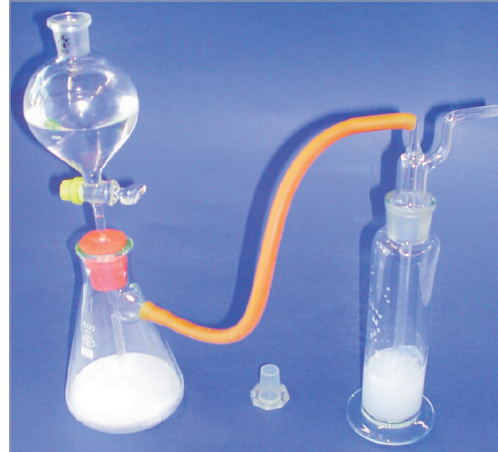
FIGURA 4 L'apparato gorgogliatore dopo la reazione di decomposizione di \text{NaHSO}_3
