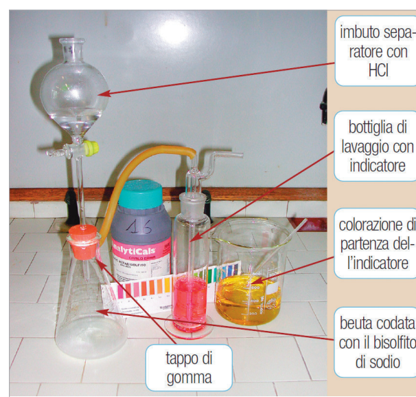
FIGURA 2 Colorazione rossa dell'indicatore universale dovuta alla reazione con la \text{SO}_2
