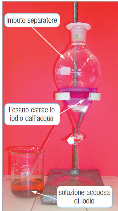
FIGURA 7 Estrazione dello iodio ( I_2 ) da parte dell'esano
