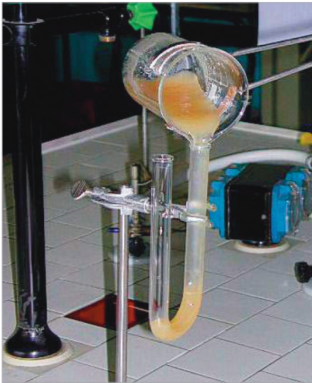
FIGURA 5 Costruzione del ponte salino
