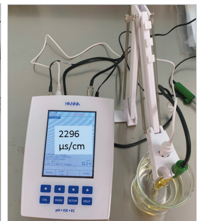
FIGURA 4 La conducibilità della soluzione di cloruro sodico ( 2.296\mu S )
