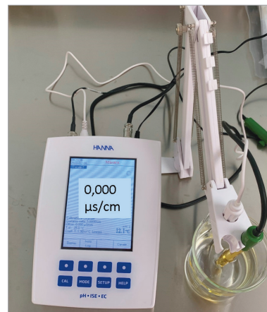
FIGURA 3 La conducibilità dell'alcol etilico ( 0\mu S )
