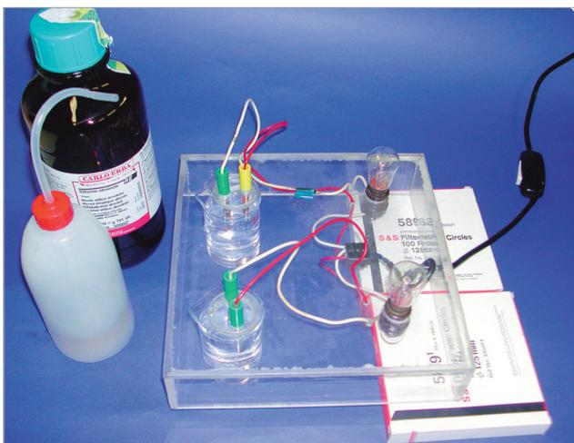
**FIGURA 1** La strumentazione per verificare la conducibilità dei liquidi
