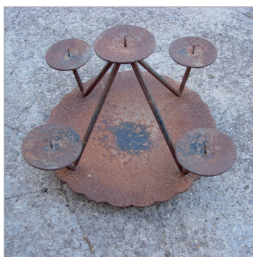
FIGURA 36 Esempi di corrosione
