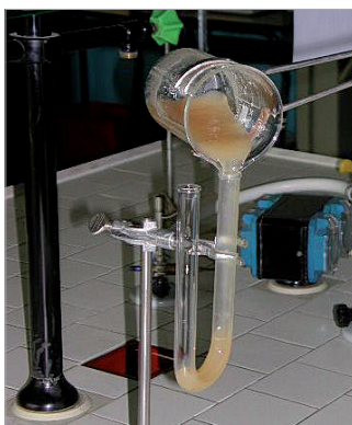
FIGURA 2 Costruzione del ponte salino
