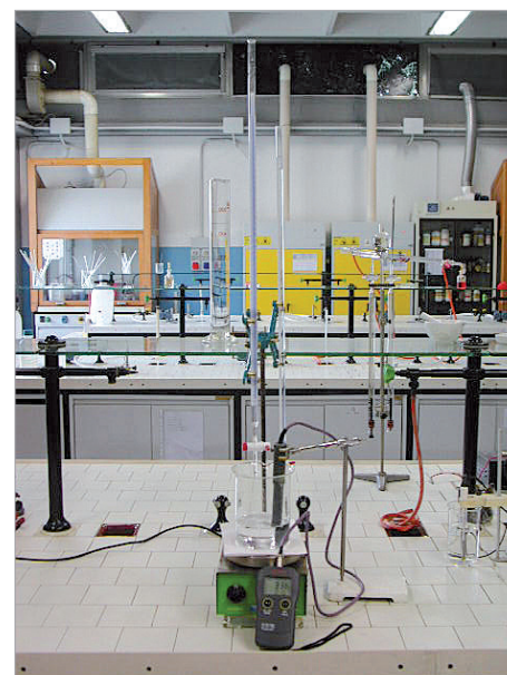
FIGURA 34 Apparecchiature per titolazione conduttimetrica
