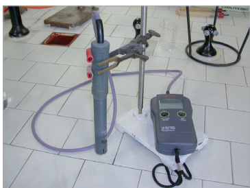
FIGURA 28 Un conduttimetro portatile
