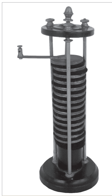
FIGURA 4 La pila di Volta (inventata nel giugno del 1775)
