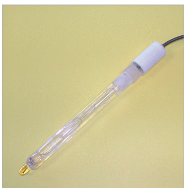
FIGURA 10 Elettrodo di vetro di un moderno piaccametro
