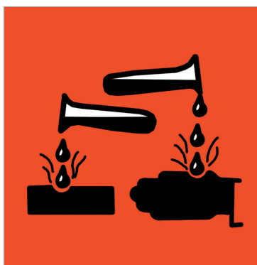
FIGURA 14 Simbolo di pericolo (corrosivo) relativo ad acidi e basi concentrati
