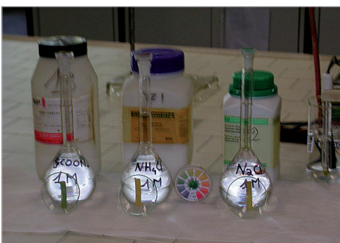
FIGURA 24 Soluzioni per le idrolisi. A sinistra acetato di sodio (idrolisi basica), al centro cloruro di ammonio (idrolisi acida) e a destra cloruro di sodio (nessuna idrolisi)
