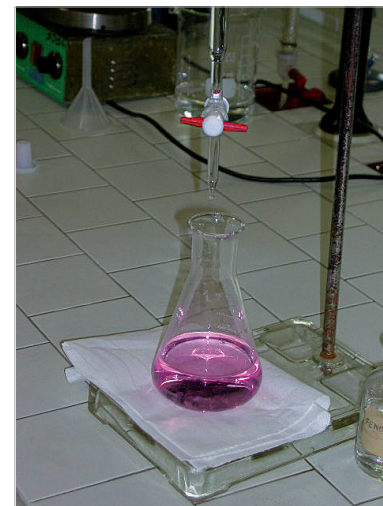
FIGURA 19 Titolazione di HCl con NaOH con indicatore fenolftaleina dopo il punto equivalente
