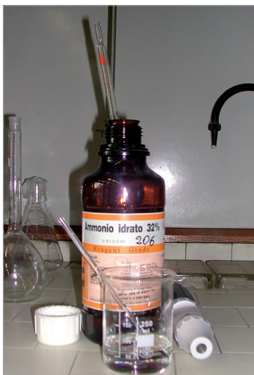
FIGURA 29 Prelievo della soluzione concentrata di idrossido di ammonio ( \text{NH}_4\text{OH} ), detta anche ammonio idrato
