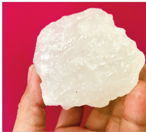
FIGURA 2 Cristalli di allume di rocca [ KAl(SO_4)_2 \cdot 12H_2O ]
