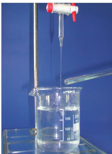
FIGURA 1 Il flusso dell'esano con un campo elettrico
