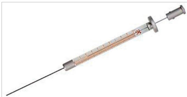
FIGURA 8 Una siringa per gascromatografia
