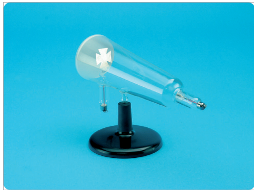
FIGURA 6 Tubo catodico con croce di Malta
