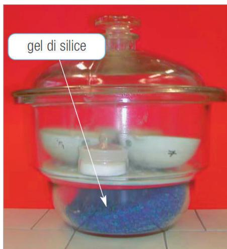
FIGURA 2 Un essiccatore. Quando il gel di silice è di colore azzurro è secco, quando il colore diventa rosa è umido
