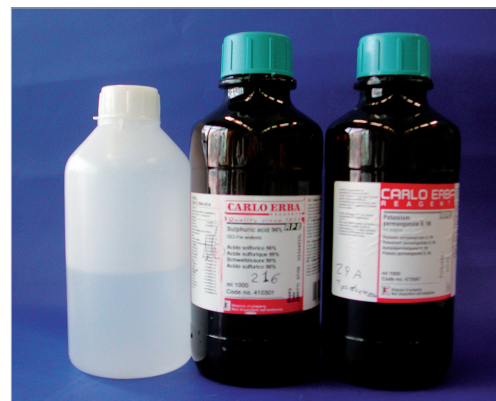
FIGURA 14 I reagenti della reazione (da sinistra acido ossalico, acido solforico e permanganato di potassio)
