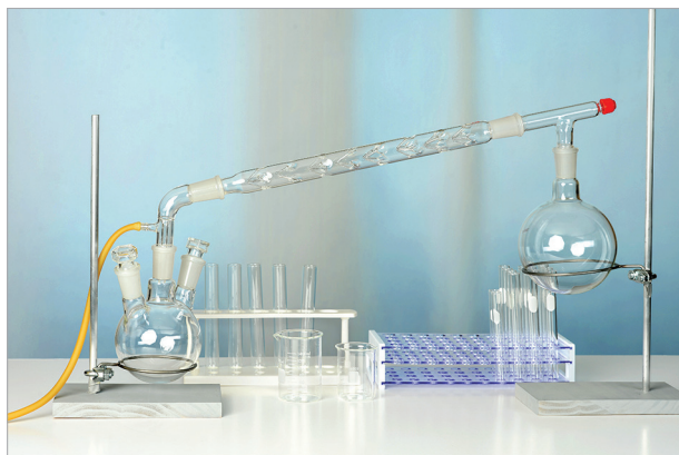
FIGURA 4 Apparecchiatura per la distillazione
