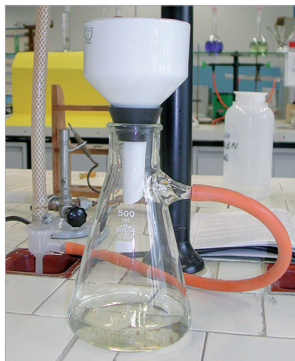
FIGURA 2 Filtrazione a pressione ridotta
