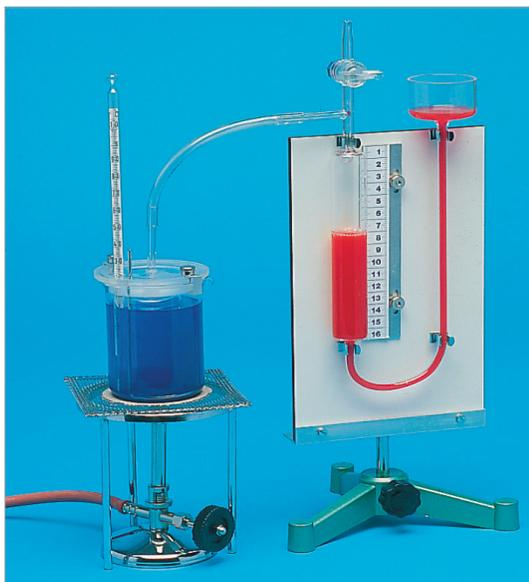
FIGURA 3 Apparecchiatura per la dimostrazione della legge di Charles
