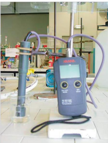
**FIGURA 1** Apparecchiatura per la determinazione della conducibilità
