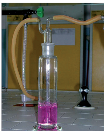
FIGURA 9 Quando si sviluppa dal pallone a tre colli centrale l'anidride carbonica (CO 2 ), il colorante violetto della bottiglia a sinistra comincia a decolorarsi
