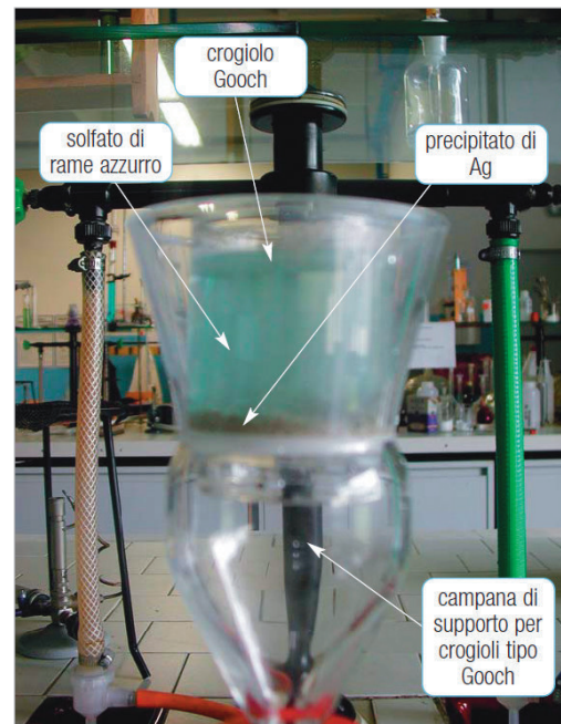
FIGURA 5 L'apparato per la filtrazione
