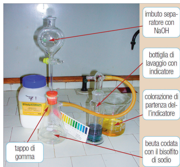
FIGURA 3 Colorazione blu dell'indicatore universale dovuta alla reazione con la \text{NH}_3
