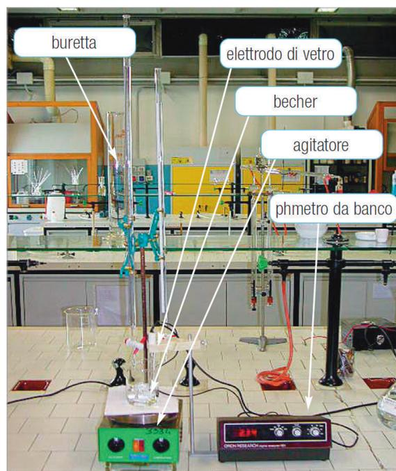
**FIGURA 1** Apparecchiatura per la titolazione potenziometrica
