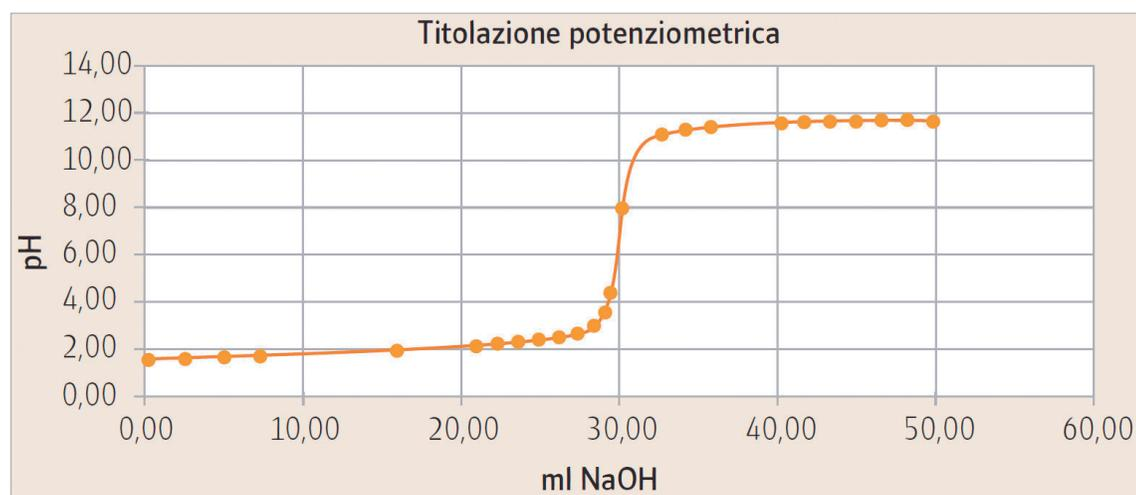
**FIGURA 2** Grafico della titolazione potenziometrica
