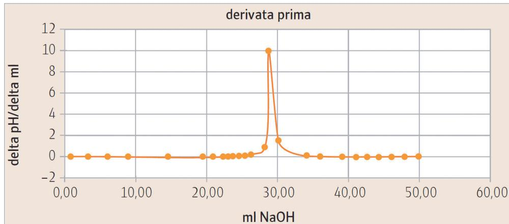
FIGURA 3 Grafico della derivata prima della titolazione potenziometrica
